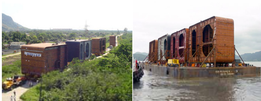
Figura 20: Transporte dos blocos da P-51 da NUCLEP para o estaleiro BrasFELS (Foto: NUCLEP)
